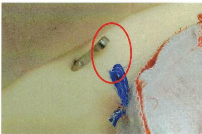
**3.** Důležité je při výměně potahu „jenom“ uvolnit spojení kovového háčku s látkovým očkem potahu.
