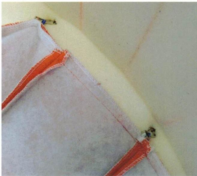
**1.** Potah s vnitřkem z pěnové hmoty je u polstrovaní sedáku spojen pomocí háčku s opěradlem. Na tomto háčku je přivázán jak potah, tak napínací lanko, které prochází pěnovým vnitřkem.
